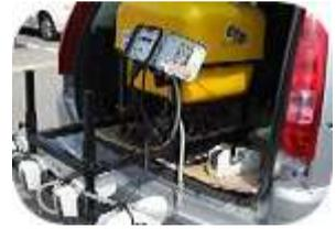
*Buses de détection des herbes par rayons infrarouge sur sol uni et fermé*
