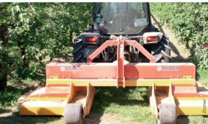
Un équipement spécifique à l'entretien de la partie centrale de l'interrang nécessitera de disposer de deux outils : un broyeur qui évite la bande florale et un deuxième pour le broyage intégral de l'interrang. Le fauchage à mi-hauteur dans bande fleurie ne peut pas être réalisé.
