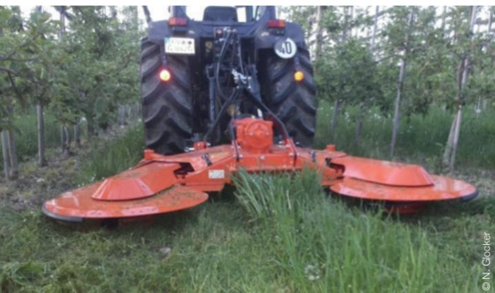
Plusieurs modèles anciens permettent d'enlever un disque de telle façon de conserver la bande florale au milieu de l'interrang. Avis aux amateurs pour adapter les broyeurs plus modernes !
