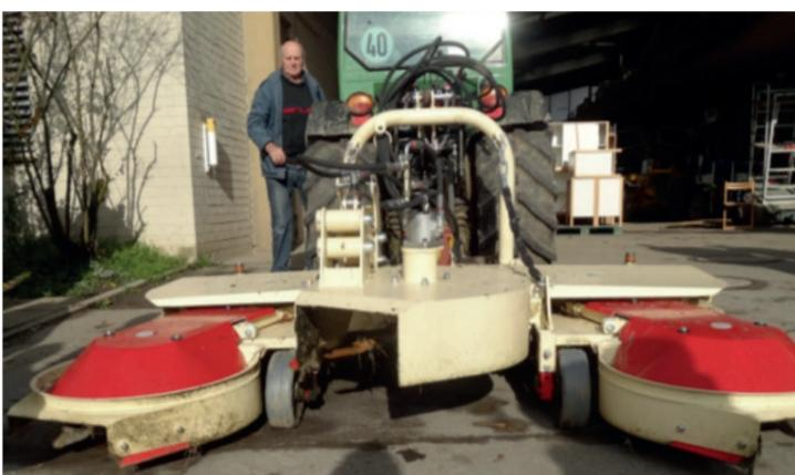
Certains broyeurs permettent d'adapter la hauteur dans la partie centrale de l'interrang pendant que les bords sont broyés à ras.
