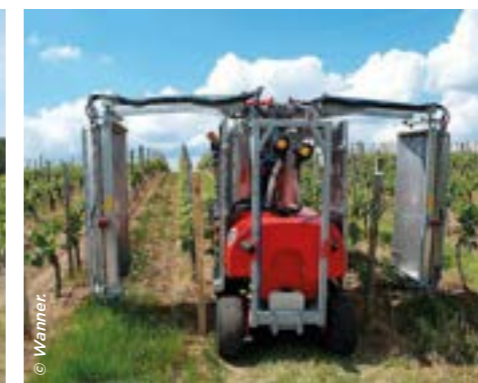
Pulvérisateur à jet porté à panneaux récupérateurs
