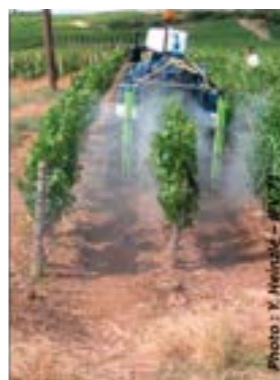
Buses à turbulence classiques
