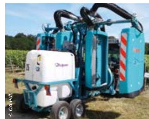
Tunnel de traitement
