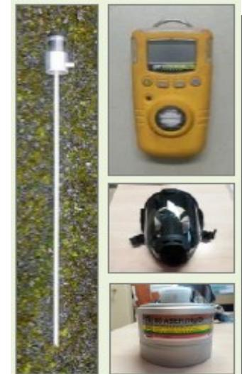
Gaz PH3, matériel de lutte (canne, sonde, détecteur masque, filtres, étalonnage appareil ...), main d'œuvre, prestation de service
