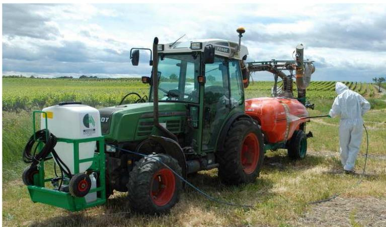
Le lavage s'effectue en deux temps : pulvérisation de détergent par jet basse pression puis nettoyage grâce au jet haute pression
