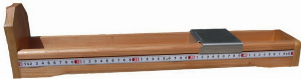
► Appareil de mesure de la longueur de la patte arrière des ongulés : Guyapon
