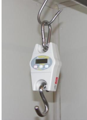
▶ Peson dynamomètre digital
